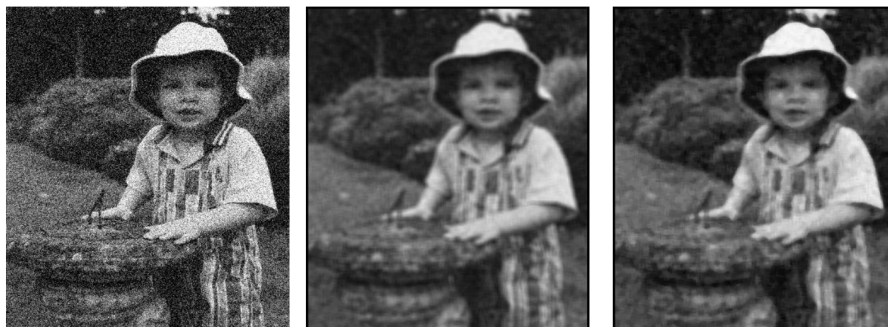
7.24. ábra. Rendre: zajjal terhelt kép, átlagoló szűrés eredménye, medián szűrés eredménye.
