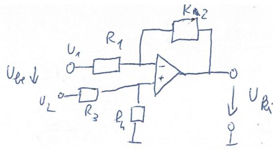
$$U_{R_1} = - U_1 \cdot \frac{R_2}{R_1} + U_2 \cdot \frac{R_4}{R_3 + R_4} \cdot \left( 1 + \frac{R_2}{R_1} \right)$$
