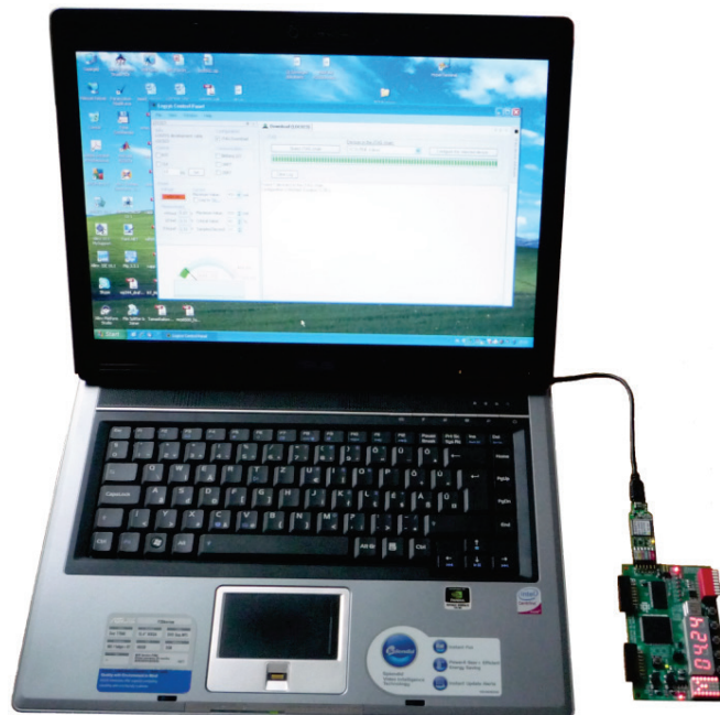
3-1. ábra: A LOGSYS fejlesztő kábel használata.
