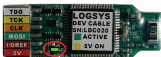
3-14. ábra: Az aktív kommunikációt jelző zöld LED.
