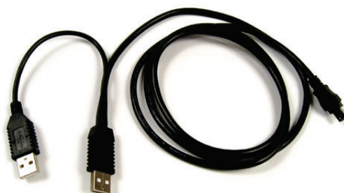
3-9. ábra: Az Y-típusú USB kábel kettőzött USB A csatlakozóval.
