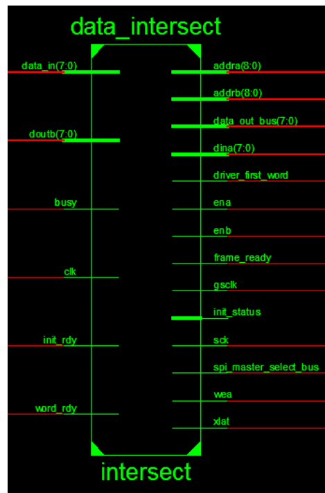
23. ábra az FPGA központi moduljának logikai diagramja
